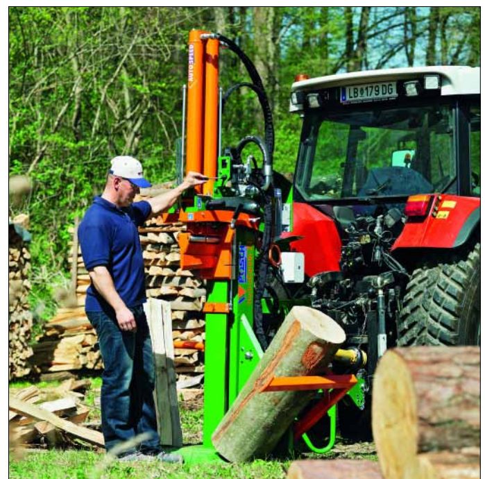
Abb. 7: Eine hydraulische Stammhebevorrichtung bringt das Stammholz an die richtige Spaltposition und schont somit den Rücken des Bedieners. Das Heben des Stammes erfolgt unabhängig vom Spaltzyklus mittels eigenem Hydraulikventil.
