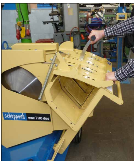
Abb. 3: Wipp-Kreissäge mit zusätzlicher Klappe über dem Sägekanal gegen das Eingreifen
