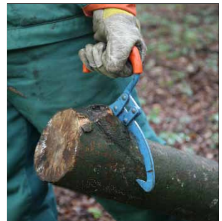
Abb. 6: Mit der Packzange kann Holz gut aufgenommen und in aufrechter Körperhaltung ergonomisch günstig vorgeliefert werden.
