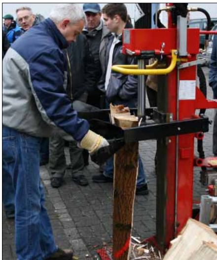
Abb. 1: Die Zweihand-Bedienung des Hydraulikspalters muss funktionieren, bestimmungsgemäß eingesetzt werden und das zu spaltende Holz fixiert sein. Der Bedienhebel fungiert gleichzeitig als Haltevorrichtung, so wird ausgeschlossen, dass Hände oder Finger in den Gefahrenbereich kommen und gequetscht oder abgetrennt werden.
