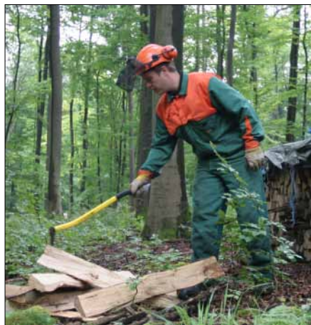
Abb. 5: Mit dem Sappie können Meterstücke einfach und den Rücken schonend hergeholt, aufgenommen und zum Holzstapel geliefert werden.
